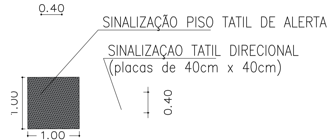
14 | DETALHE PISO TÁTIL ESCALA 1/75
